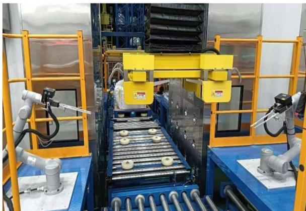
图 3-7 机器人 3D 视觉智能吨袋自动上下料系统
